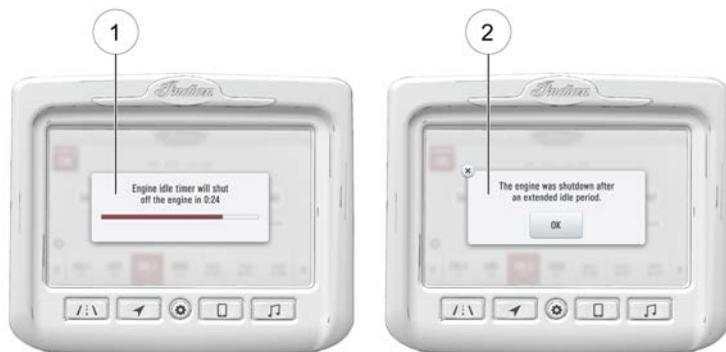
Para motocicletas equipadas con Ride Command, una notificación mostrará un temporizador para advertir que el motor está por apagarse ①. Cuando el tiempo haya transcurrido y el motor se apague, se mostrará una notificación subsiguiente ②. Una vez apagado el motor, puede volver a arrancarse al presionar el interruptor de arranque.
