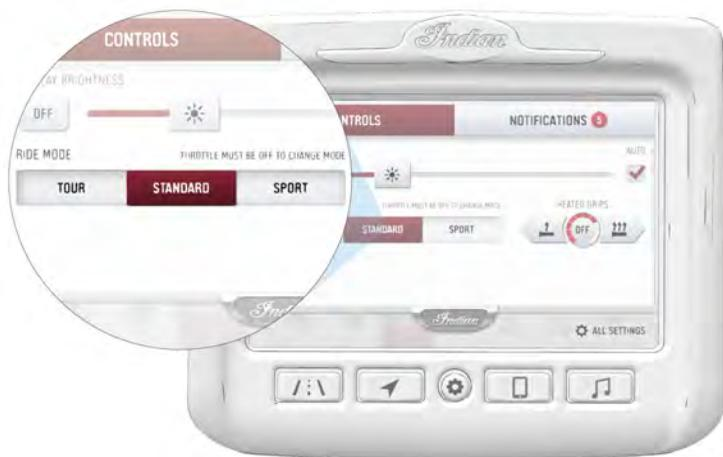
Puede elegir entre tres modos de conducción: Tour, Standard (estándar) o Sport (deportivo) para obtener una experiencia personalizada para su estilo de conducción. El mapa del acelerador de cada modo de conducción se ha diseñado pensando en una aplicación específica, lo que da como resultado una motocicleta con tres personalidades distintas.
