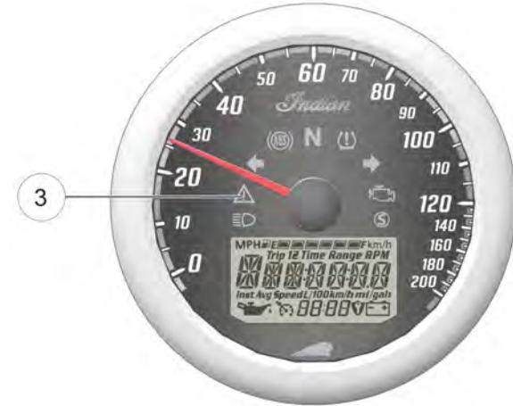
En las motocicletas con Ride Command, una notificación mostrará un temporizador para advertir que el motor está a punto de apagarse ①. Después de que haya pasado tiempo y el motor se haya apagado, se mostrará una notificación ②. Después de que el motor se apague, se puede volver a encender si se pulsa el interruptor de arranque.
