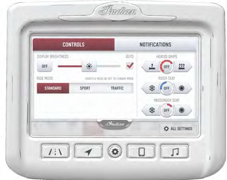
Desde el panel de control puede acceder a la configuración, ajustar el brillo de la pantalla, seleccionar el modo de conducción y los controles de climatización del vehículo.
